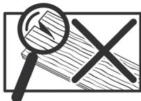
O revestimento do pavimento deve ser examinado antes da instalação para detetar quaisquer defeitos visíveis. Os pavimentos devem ser do mesmo lote de produção. Se existirem defeitos visíveis, informe a GERFLOR e não inicie a instalação sem a sua aprovação prévia.
